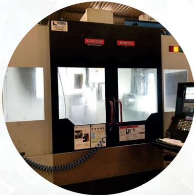
**CENTRE D'USINAGE 4 AXES
