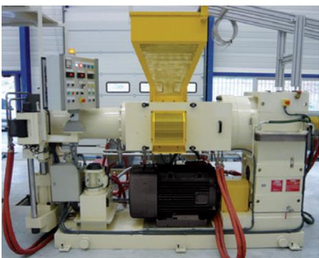
**L'extrusion** est un process continu employé dans des industries comme celles du plastique & caoutchouc, de l'agro-alimentaire et de l'alimentation animale. La consommation énergétique des extrudeuses à vis est significative et clé, elle dépend pour l'essentiel du système d'entraînement principal.
