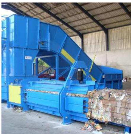
Les presses à balles verticales et horizontales forment des balles de 30 Kg jusqu'à 1200 Kg. Les plus performantes traitent jusqu'à plusieurs tonnes par heure.
