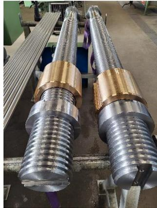
Vis + écrou porteur et sécurité
