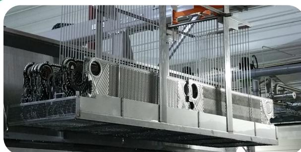
Ligne de dégraissage /détartrage robotisée
