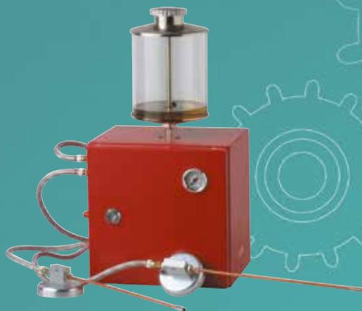
Par le jeu d'un système de deux tuyaux concentriques, l'air et l'huile sont amenés dans la buse sans être mélangés. A l'extrémité de cette dernière, l'air vient éclater et catapulter les microgouttes d'huile ainsi formées.
