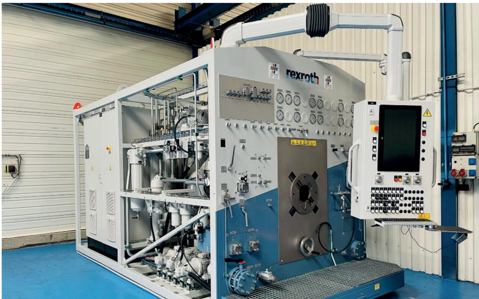
► **Le banc d'essai EDHD** permet de réaliser des tests afin de déterminer avec précision et fiabilité le **fonctionnement correct** des pompes à engrenage interne ainsi que des pompes et moteurs à pistons. Grâce à cet équipement, nous nous assurons de la **parfaite étanchéité statique et dynamique des pièces** qui doivent être réparées. Nous pouvons également réaliser des **misés en épreuve** avec vitesse de rotation ou réglages spécifiques.
