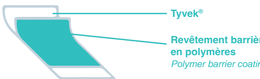
Tyvek® Revêtement barrière en polymères Polymer barrier coating Film protecteur Protective film Revêtement barrière en polymères Polymer barrier coating
