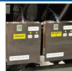
Les Single Pass sont équipées d'un système d'alimentation en encre à double pression négative. Cela garantit un volume d'encre parfaitement régulé pour une impression stable.
