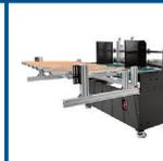
En option, les chargeurs automatiques de cartons ou de sacs assurent l'alimentation régulière et rapide, de la machine.
