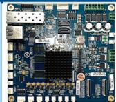
Carte mère spécialement développée pour cette application. Assure un ajustement parfait de la machine, une forte stabilité, une gestion automatique de l'image, un saut automatique des zones transparentes. Prend en charge l'impression de données variables telles que le code QR, le code-barres, le texte, etc., et l'impression continue multitâche sans interruption.
