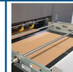
Grâce à une bande transporteuse perforée et à des guidages mécaniques réglables, le matériau est parfaitement guidé jusqu'à la zone d'impression.
