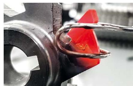
*Brasage localisé avec contrôle de température du PCD et de l'outil coupant.*
