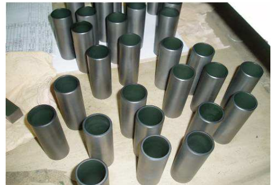
Analyseurs – revêtement intérieur sur titane
