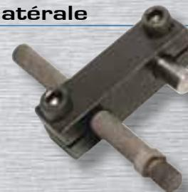
La butée latérale se positionne en 6 points M8 sur le côté de la barre 09-015, elle est réglable en hauteur et en longueur. Tige d'appui Ø 8mm.
