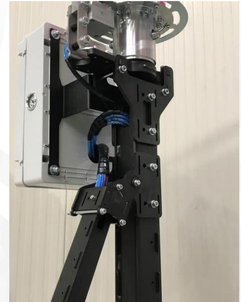
Montage avec vis et emboitement. Passage des câbles à l'intérieur
