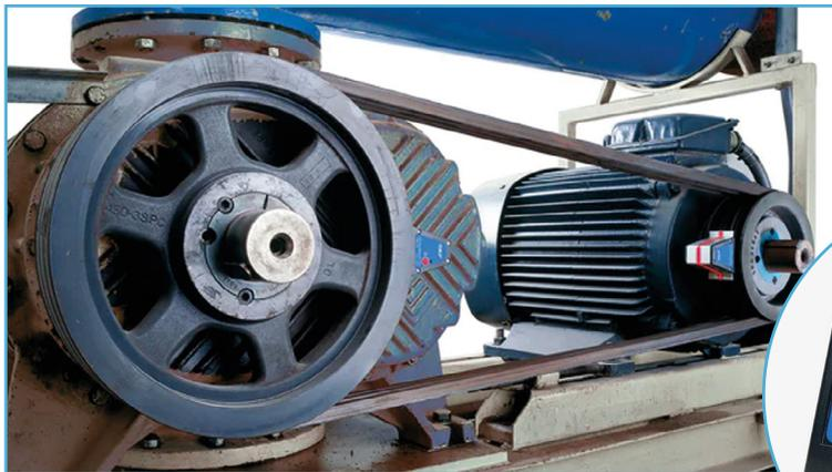
Pour les alignements poulies-courroies, nous réglons la tension des courroies par mesure à ultrasons.
