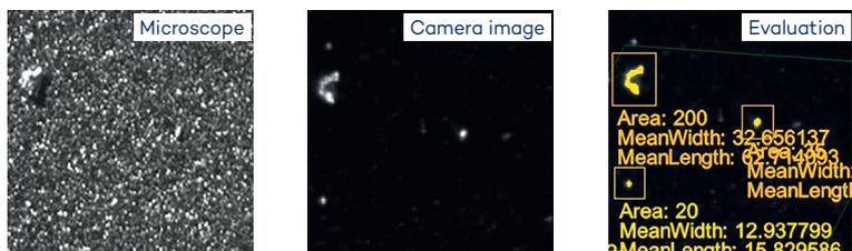
Détection de particules sur les électrodes de batterie
