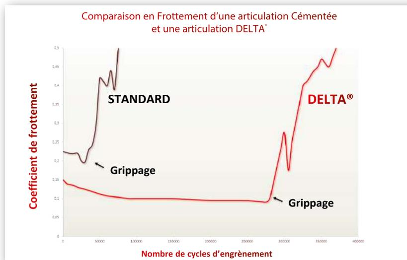
Grâce à la dureté supérieure, un faible coefficient de frottement et une affinité chimique compatible, les chaînes **DELTA® HR** ont une **durée de vie supérieure aux chaînes standards**, particulièrement dans les applications sévères (abrasion, à-coups, chocs,...).
