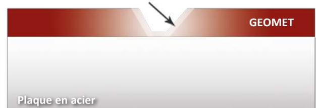
Dans les conditions de l'essai en Brouillard Salin, le traitement GEOMET® utilisé sur les chaînes DELTA® TITANIUM 2 a une tenue bien meilleure à la corrosion. En effet, la rouille rouge n'apparaît qu'après 450 heures contre 100 heures pour les pièces bi-chromatées (voir figure ci-dessous).
