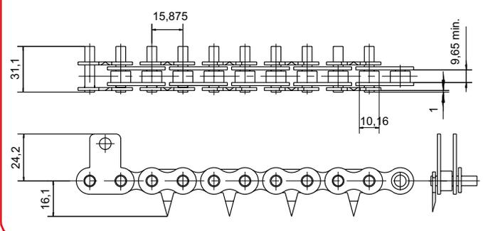
Chaîne au pas de 12,7 suivant plan : 5083-82
