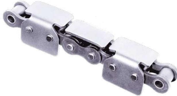
Exemple d'utilisation : transport de pièces qui peuvent venir en accumulation sur le transporteur, la chaîne continuant à avancer, les pièces glissent sur les équerres chanfreinées. Ces chanfreins ou "rabats" évitent tout marquage des pièces transportées. Ce type de chaînes peut être réalisé en chaîne double.
