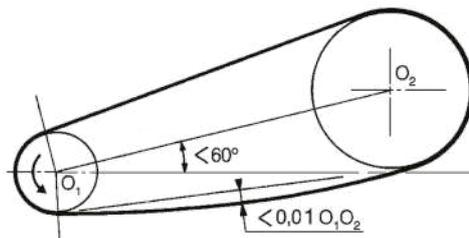
Dans le cas où cet angle serait supérieur à  $60^\circ$ , et à fortiori pour une transmission verticale, des précautions sont à prendre pour assurer un bon engrènement de la chaîne sur la roue inférieure,
