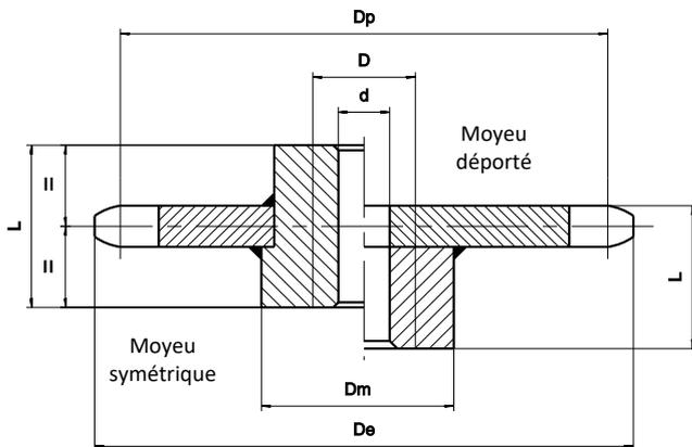
Toutes nos roues sont livrées avec la denture brute d'oxycoupage ou de fonderie pour les chaînes équipées de galets lisses et de galets épaulés.
