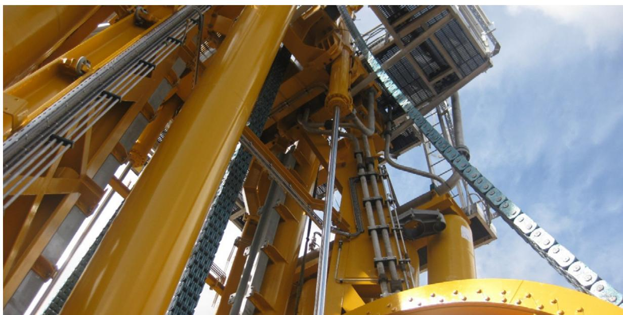
*SEDIS a développé une chaîne VERTE® unique pour l'industrie offshore (systèmes de compensation de houle sur les navires de forage)*
