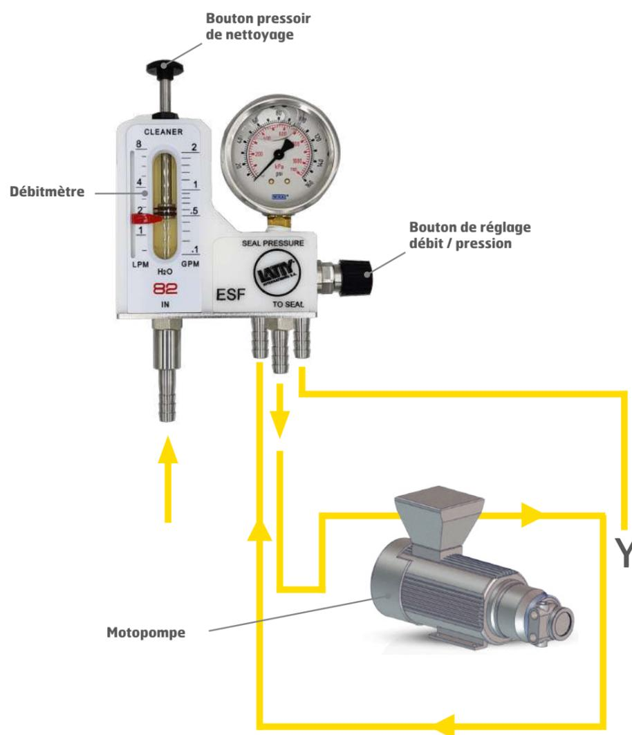
Le contrôleur de débit est conçu pour les applications où un débit d'eau ininterrompu est requis pour le refroidissement et la lubrification des systèmes d'étanchéité.
