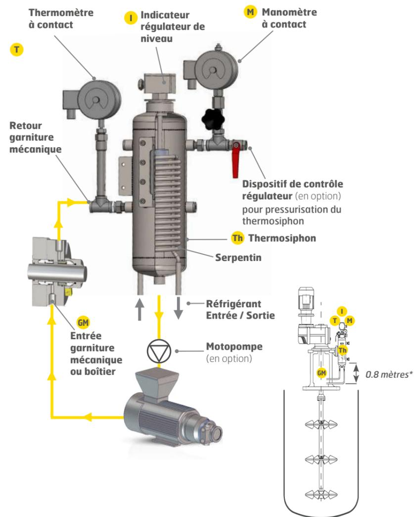
La gamme LATTYlub Pot permet de réguler et de contrôler la température de vos systèmes d'étanchéité afin d'améliorer la durée de vie de vos équipements.
