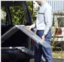
La construction en alliage léger permet d'obtenir une rampe de 40 Kg seulement. Équipé de système de fixation rapide qui facilite le transfert de la rampe à un autre véhicule. Facile à installer avec un simple kit de montage. Plaques réglables à l'avant et l'arrière de la rampe pour faciliter le chargement. Équipée d'une broche spéciale pour utiliser la rampe du pont, qui permet la connexion entre deux pistes.
