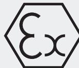
L'ATEX est une directive européenne (2014/34/CE) relative aux équipements, composants et systèmes de protection électriques et mécaniques antidéflagrants. Elle concerne la fabrication de produits utilisés dans des atmosphères potentiellement explosives.
