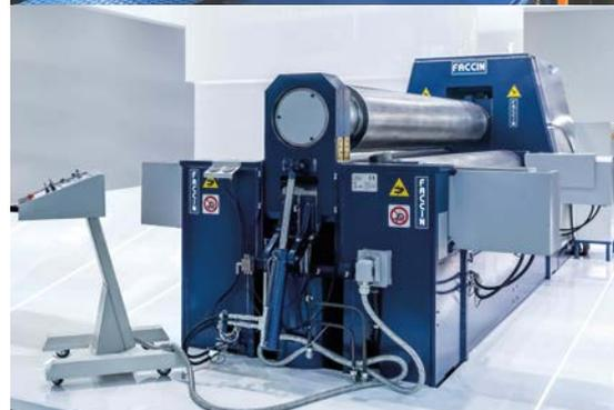
Grâce à la position horizontale des vérins pour le mouvement des rouleaux inférieurs, les rouleuses HAV à 3 rouleaux à axe variable sont équipées d'un plan de travail à hauteur réduite. Aucune fondation n'est donc nécessaire, même pour des rouleuses d'une capacité allant jusqu'à 40 mm.
