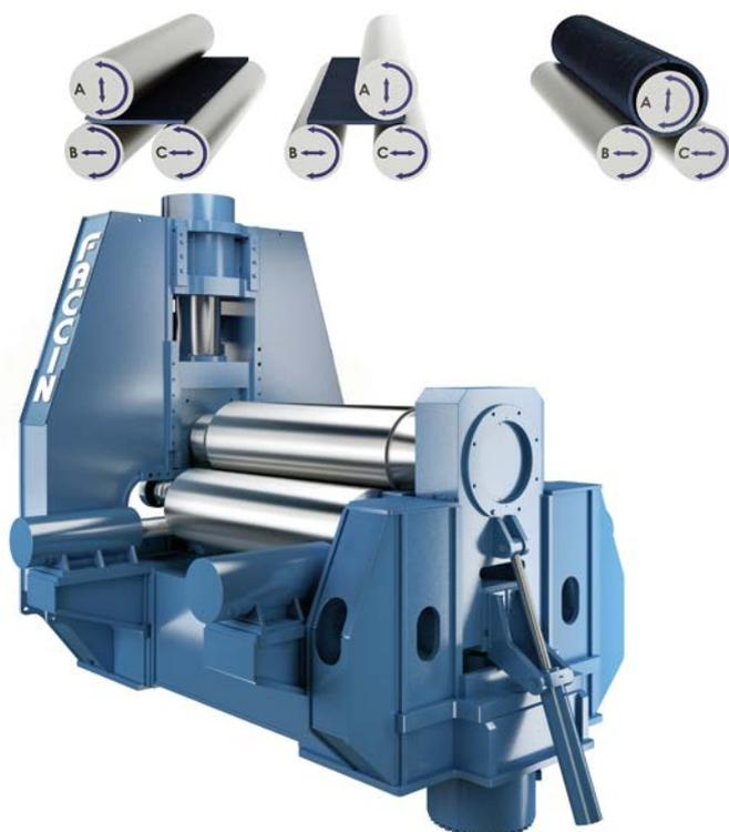
Puissance de roulage élevée combinée avec une précision de croquage maximale: la série HAV des rouleuses à géométrie variable à 3 rouleaux est le modèle au plus haut niveau de sa catégorie en termes de performance et de polyvalence.
