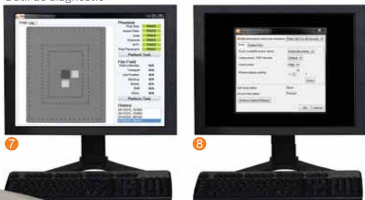
**7 Statut du système** - L'outil de diagnostic (accessoire en option) permet à l'utilisateur de surveiller la stabilité du système conformément à la norme ASTM E2445.
