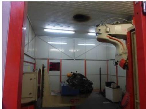
L'encoffrement de la zone de soudage doit s'effectuer de la manière la plus étanche possible en partie haute et contenir l'ensemble du volume d'émission de fumée. La hauteur des 4 parois latérales doit être telle que l'émission s'effectue toujours dans l'enceinte.
