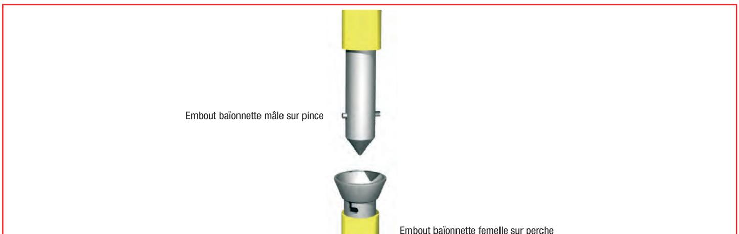
Pour l'utilisation sur ligne aérienne haute (entre 5 et 10 m) l'embout baïonnette peut être équipé d'une cloche qui assure la fonction de guidage de l'embout de perche vers l'embout sur pince.
