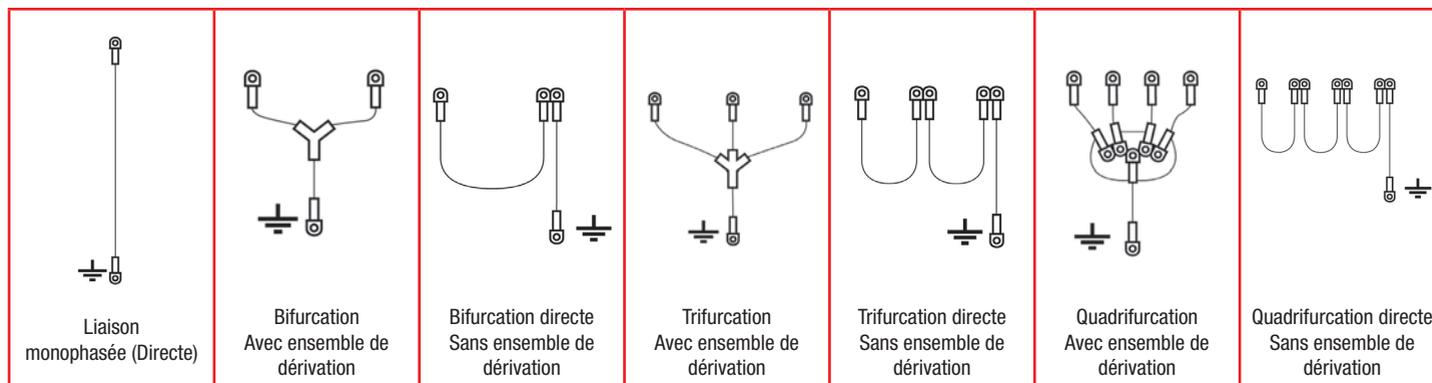
**4.2 Longueurs des différents câbles de MALT/CC.** Les longueurs sont choisies « sur mesure » en fonction des distances, sur la zone de travail, entre le point de pose de l'étau de terre et les points de pose des pinces pour conducteurs.
