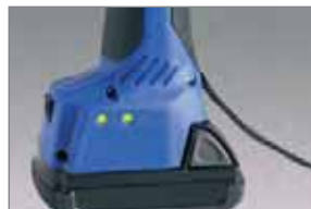
Voyants indiquant l'état de charge de la batterie et le contrôle si nécessaire d'une intervention de maintenance
