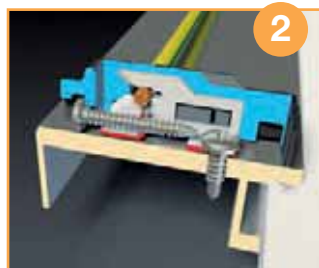
Mise en contact des lames avec le conducteur vert jaune par vissage
