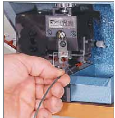
La cosse ou le clip suivant est automatiquement positionné sous les matrices.
