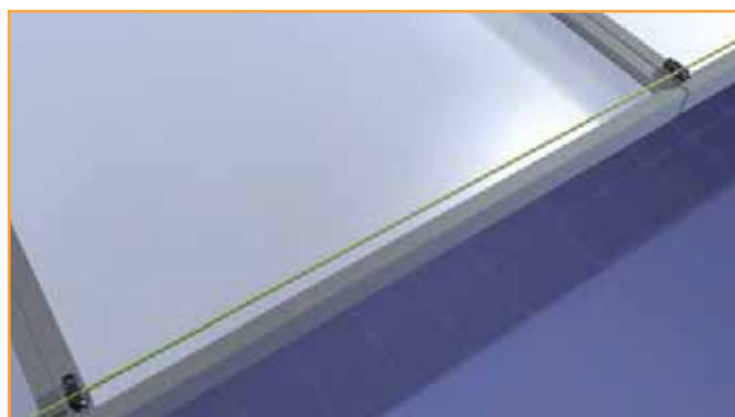
Ce mode de pose permet le démontage d'un panneau sans rupture de la liaison équipotentielle.
