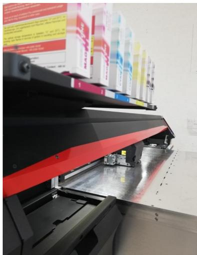
L'impression digitale et la sérigraphie sont des procédés qui permettent d'intégrer dans la couche d'alumine (créée par l'anodisation réalisée préalablement) des textes, des images et des photographies.
