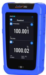
15 types de thermocouple + mV
