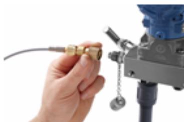
Un raccord rapide avec valve antiretour installé sur le manifold facilite le raccordement d'un calibrateur via un flexible
