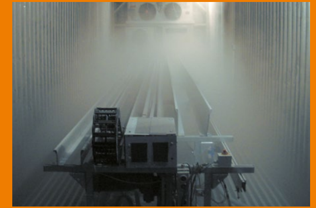
Test de froid sur câbles et chaînes porte-câbles à -40°C dans la chambre climatique igus®
