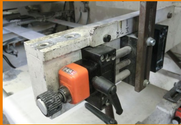
Cette table linéaire à vis avec accessoires assure des changements de format rapides et reproductibles avec précision.
