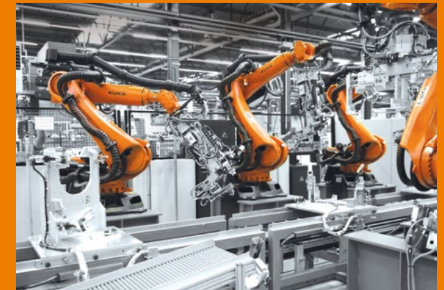
Chaînes porte-câbles triflex® R pour les mouvements complexes de robots
