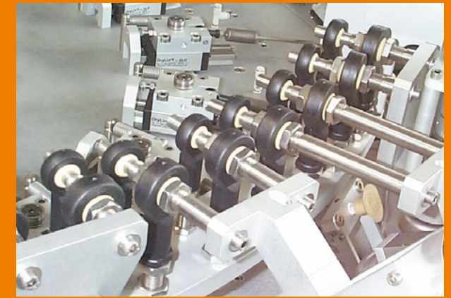
Les embouts à rotule igubal® en polymères s'affirment sans problème dans ce milieu exigeant.
