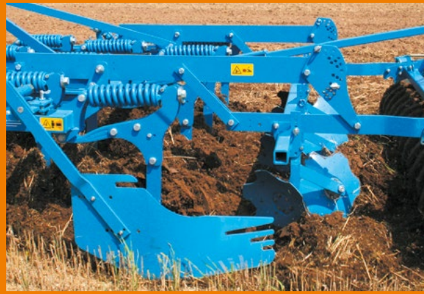
Pas besoin de graissage dans l'élément de surcharge du cultivateur Karat 9.
