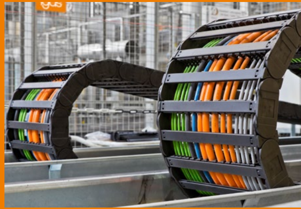
Essai longue durée : durée de vie et usure 10 milliards de cycles par an pour des chaînes porte-câbles dans le laboratoire e-chain® et chainflex®
