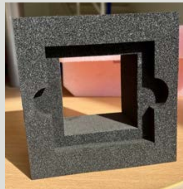
Plusieurs épaisseurs de PER découpées au jet d'eau sont assemblées, créant un espace de calage pour un coffret
