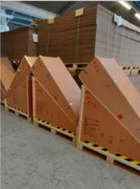
Caisses palette Bois inclinées permettant le transport de pièces aéronautiques
