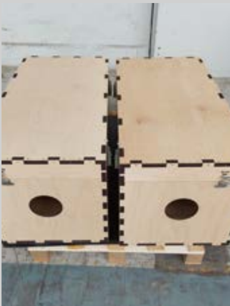
Caisses bois qualité vernis avec découpe laser haute précision et haut de gamme avec des assemblages Tenon Mortaise, destinées à une fonction d'élément mobilier pour une entité de recherches techniques
