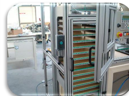
Magasins automatiques blisters
