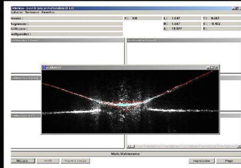
Un guidage dynamique et précis assuré par le capteur 3D Visionic capable de résister à la chaleur et à l'éblouissement provoqué par le process de soudage.
