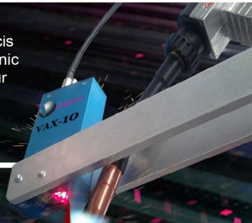
Le capteur 3D visionic reste performant sur tous types de géométries de joint
