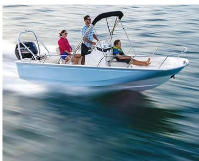
Ce bateau de plaisance bénéficie de pièces de structure et d'une coque, en composite fibre de verre et résine Elium®. Ces éléments, grâce à la nature thermoplastique d'Elium® (la résine
