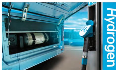
Pour le stockage haute pression (700 bars) de l'hydrogène embarqué, les réservoirs actuels sont fabriqués en composite à base de résine
