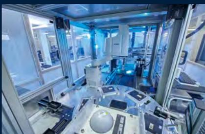
Jede Platine mit RGB-LED wird einzeln vermessen und abhängig vom vorgesehenen Verwendungszweck kalibriert. Dabei werden elektronische und optische Eigenschaften der LED erfasst und ein Farbgleich durchgeführt. Diese Daten und die hieraus resultierenden individuellen Parameter für das Modul werden auf dem Mikrocontroller gespeichert.
