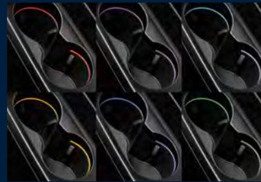
Für anspruchsvolle Farblichtanwendungen hat MENTOR eine innovative RGB-LED-Lösung entwickelt. Diese basiert auf einem intelligenten RGB-Basismodul mit integriertem Mikrocontroller, das aufgrund seiner kompakten Bauform für vielfältige Applikationen als Flächen-, Linien- und Spotlicht sowohl in der direkten, als auch in der indirekten Beleuchtung einsetzbar ist.
