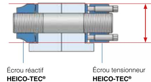
L'écrou tensionneur et l'écrou réactif HEICO-TEC® ont les mêmes dimensions
