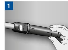
Régler la clé dynamométrique au couple de vissage recommandé.
