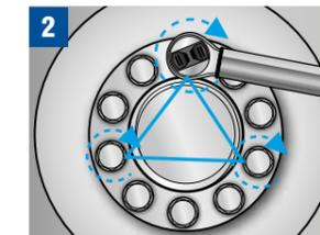
Serrer 3 vis de pression positionnées en triangle, jusqu'au couple de vissage requis, par passes successives d'1/2 tour.
