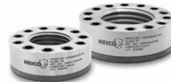
Un autre avantage réside dans le fait que les vis de pression ne dépassent pas du corps de l'écrou et ne se trouvent pas dans le flux du média environnant. Grâce à cette propriété, les vis de pression sont également largement protégées contre l'influence des fluides abrasifs. Le nombre de filets en prise est maximal compte tenu des hauteurs totales disponibles.
