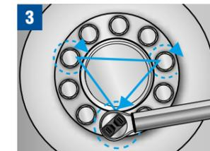
Répéter l'opération 2) sur 3 autres vis de pression, positionnées en triangle inversé par rapport à 2).
