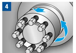
Dévisser le corps de l'écrou tensionneur et retirer la rondelle d'appui.
