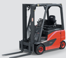
E16P - E20P Frontal électrique Capacité : 1.6 t - 2.0 t Modèles : H, L, HL
