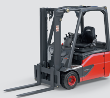
E12 - E20 Frontal électrique, 3 roues Capacité : 1.2 t - 2.0 t Modèles : C, L, H
