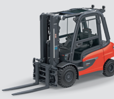
X20 - X50 Frontal électrique Capacité : 2.0 t - 5.0 t
