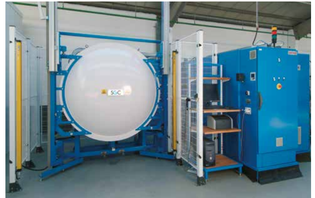
Station de remplissage du gaz SF 6
