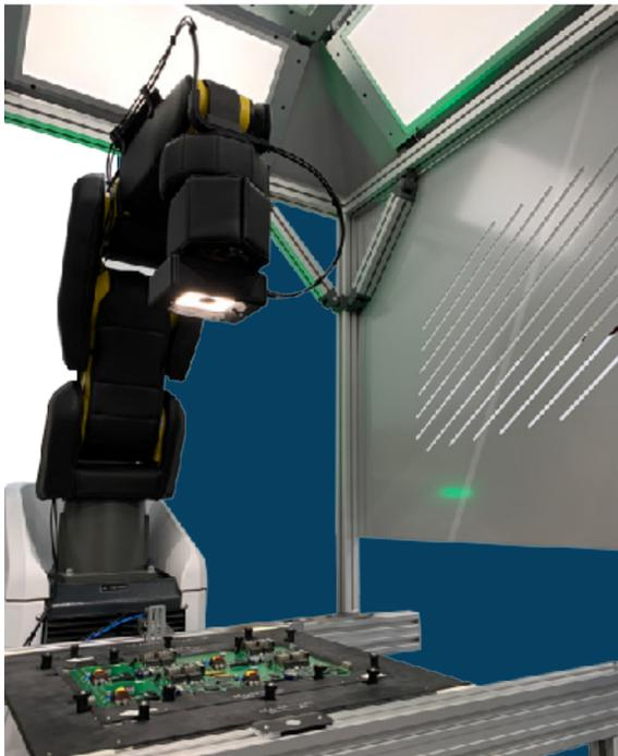
L'objectif de cette solution est d'assister le contrôle visuel par un système expert en collaboration avec les opérateurs.
