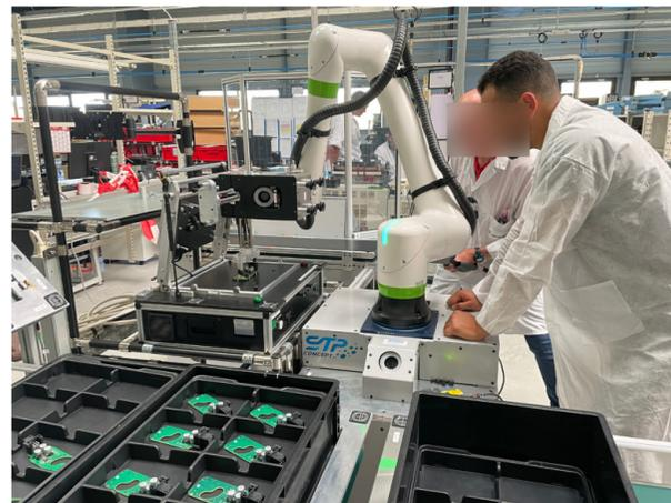
L'objectif de cette solution est d'automatiser le test de cartes électroniques des petites et moyennes séries en intégrant Robot ou Cobot dans un environnement le plus compact possible.
