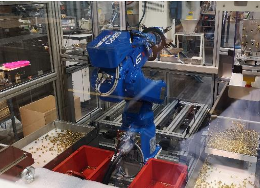
Cellule robotisée pour distribution d'inserts
