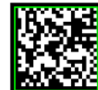
Violation de zone de silence
