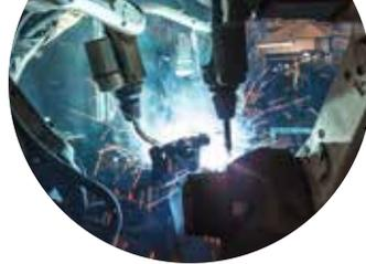
La PHL des robots de soudage est une alternative avantageuse à la programmation par apprentissage. Elle est donc de plus en plus courante chez les industriels, PMI comprises. La flexibilité offerte par la PHL est d'autant plus intéressante que les produits fabriqués sont variés, modulables ou soumis à de fréquentes adaptations, et que les séries à produire sont petites.
