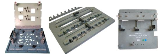
Les cadres de vague et / ou porteurs composites permettent de convoier les cartes électroniques rigides ou souples dans des vagues et / four de refusion pour souder les composants.
