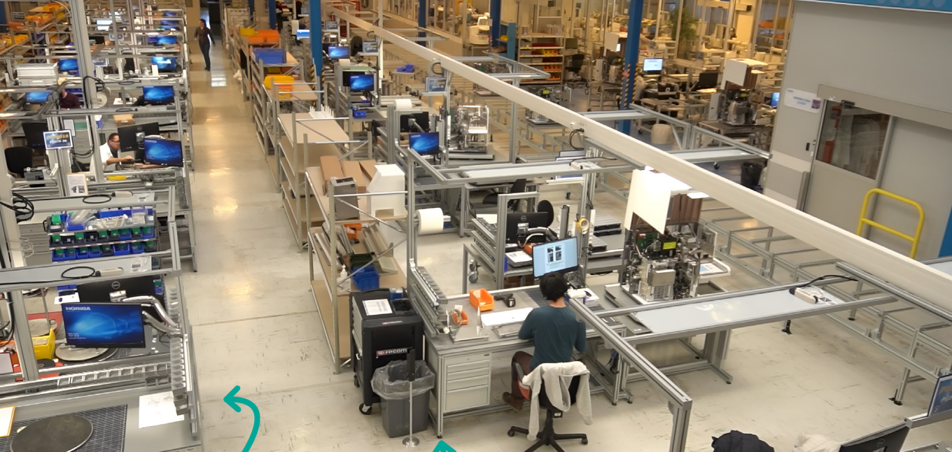
Postes ergonomiques de préparation de sous-ensembles
