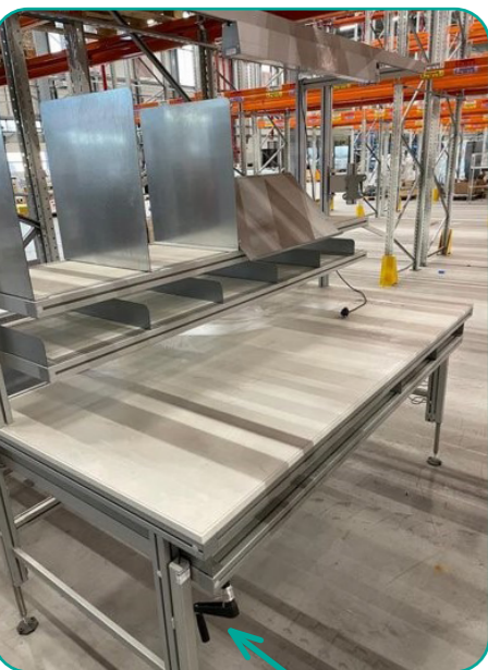
4 pieds hydrauliques télescopiques avec commande manuelle
