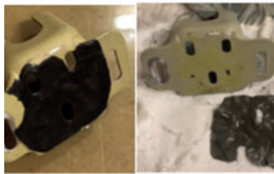
Décapage de PR
