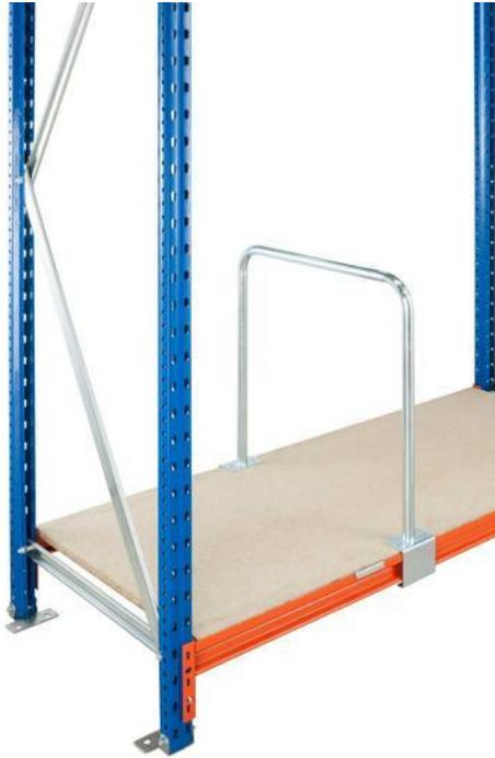
Clipsage sur longerons par effet ressort. Peut être fixé sur le platelage agglo. Finition électro zinguée. Adaptable sur lisses GV4 section 74 x 30.
