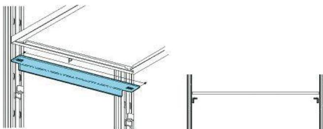
Avec l'ajout de 2 profils de renfort d'extrémité par tablette, la charge peut être augmentée.
