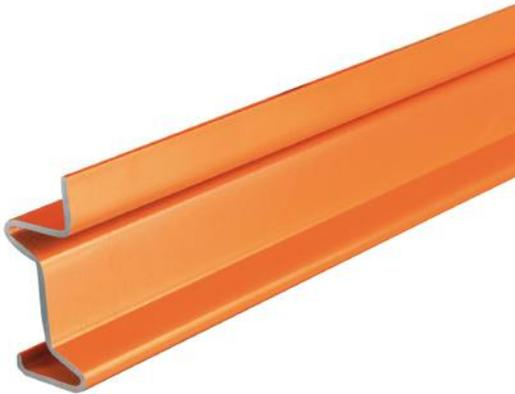
Le longeron GV4 adopte un profil Z avec feuillure section 64 ou 74 x 30 mm en acier 20/10 ème. Les pattes d'accrochage sont munies de 3 ergots qui permettent un réglage en hauteur sur les échelles tous les 50 mm sans vis ni boulon.
