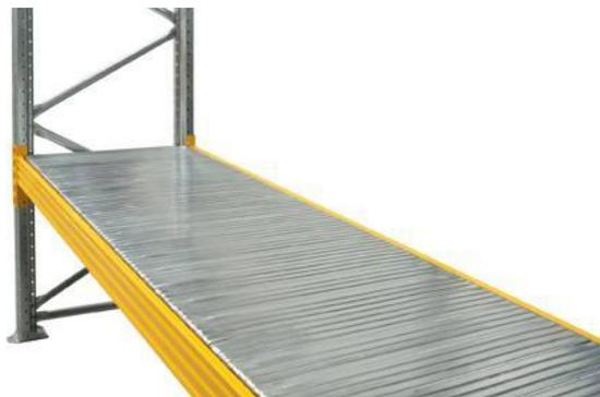
Tablette métallique à tête aplatie, vient s'insérer dans la fente sur le dessus des lisses. Charge admissible 900 kg/m<sup>2</sup> (u.r). Hauteur 29 mm.
