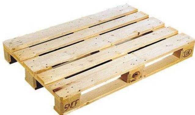
Conformes aux normes européennes ISO-EUR-SNCF-EPAL- pour la palette 800 x 1200 mm. Bois pin raboté sec et testé. Semelles en plots assemblés avec clous torsadés. Conditionnement standard de 10 palettes identiques.
