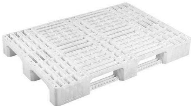
Fabrication en polyéthylène coloris blanc avec plancher ajouré. Manutention par transpalette ou chariot élévateur. Charge admissible 1500 kg en dynamique et 4000 kg en statique.
