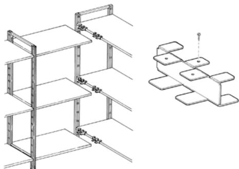
2 supports sont nécessaires par tablette. Livrés avec vis autoforeuses.
