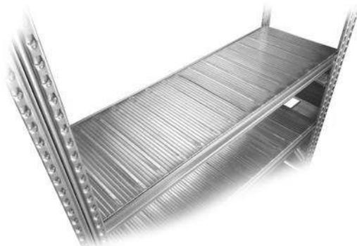
Les tablettes sont constituées de deux longerons se fixant par double point d'ancrage sur les montants des échelles et d'un dessus tôlé s'encastant dans les longerons pour former un ensemble homogène et parfaitement stable.
