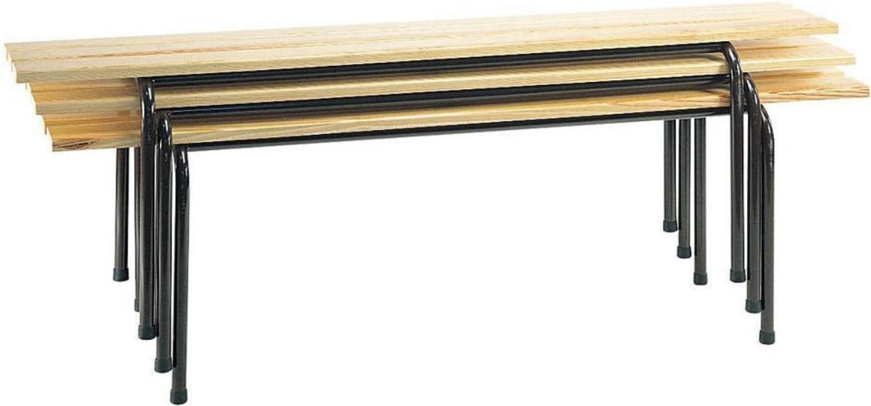
Banc avec 3 lattes en pin massif poncé et verni d'épaisseur 22 mm. Largeur d'assise 280 mm. Piètement métallique tubulaire diam. 25 mm. Peinture époxy marron foncé. Patins anti-dérapants.
