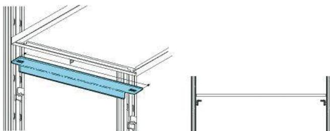
Avec l'ajout de 2 profils de renfort d'extrémité par tablette, la charge peut être augmentée. (Vendu à l'unité).
