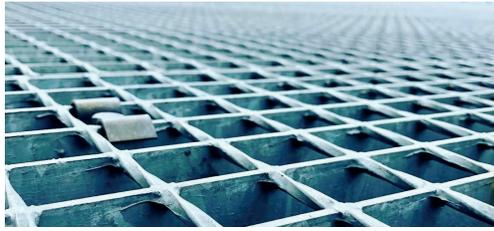
Le caillebotis électroformé se compose de barres insérantes en carrés torsadés, électrosoudées dans les barreaux porteurs. La soudure à chaque point d'intersection entre les BP et les BI lui garantit une extrême solidité et robustesse.
