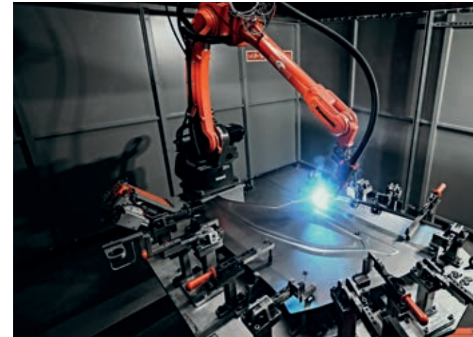
Soudage de sous-ensembles en tôle
