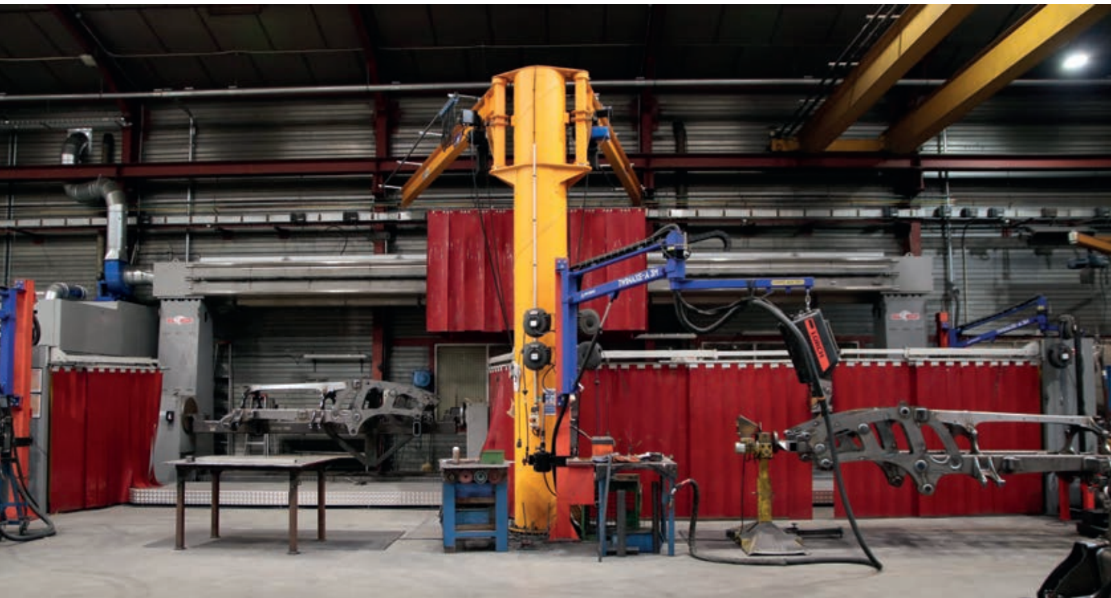
La première cellule développée par Valk Welding pour Comebo Industries s’appuie sur un robot suspendu avec un transfert aérien, pour des dimensions jusqu’à 5 m, au lieu de 3,2 m avec la machine précédente.
