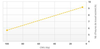
Autonomie des batteries suivant la masse de préhension [nombre de pièces] (avec préhenseur pneumatique intégré)
