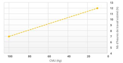
Autonomie des batteries suivant la masse de préhension [nombre de pièces] (sans préhenseur pneumatique intégré)
