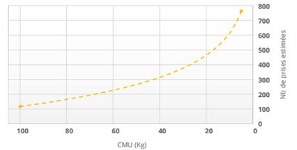
Autonomie des batteries suivant la masse de préhension [temps] (sans préhenseur pneumatique intégré)
