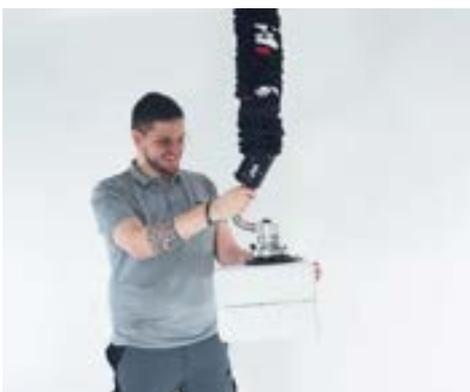
Le **FIPALIFTswift** est un tube de levage particulièrement **ergonomique** avec une capacité de levage allant jusqu'à **40kg**.
