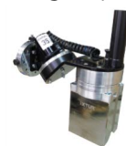
OUT039 Ventouse pneumo- magnétique
