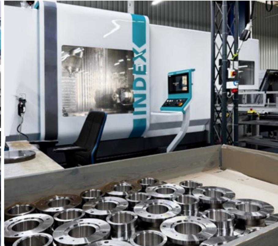
À gauche : un aperçu de l'allée INDEX chez KEB à Barntrup. Les 14 centres de tournage-fraisage et les centres de tournage verticaux INDEX y tournent presque 24 heures sur 24. En service depuis 2022 : le centre de tournage-fraisage INDEX G220 avec automatisation iXcenter (photo ci-dessus).
