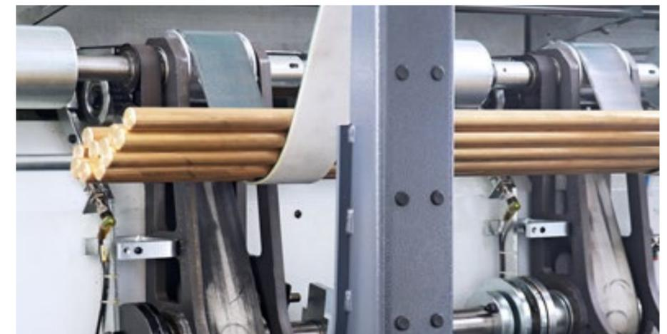
Diehl Brass Solutions, partenaire de longue date, fournit des barres en laiton que Firner Trautwein transforme sur ses tours multibroches à commande numérique.
