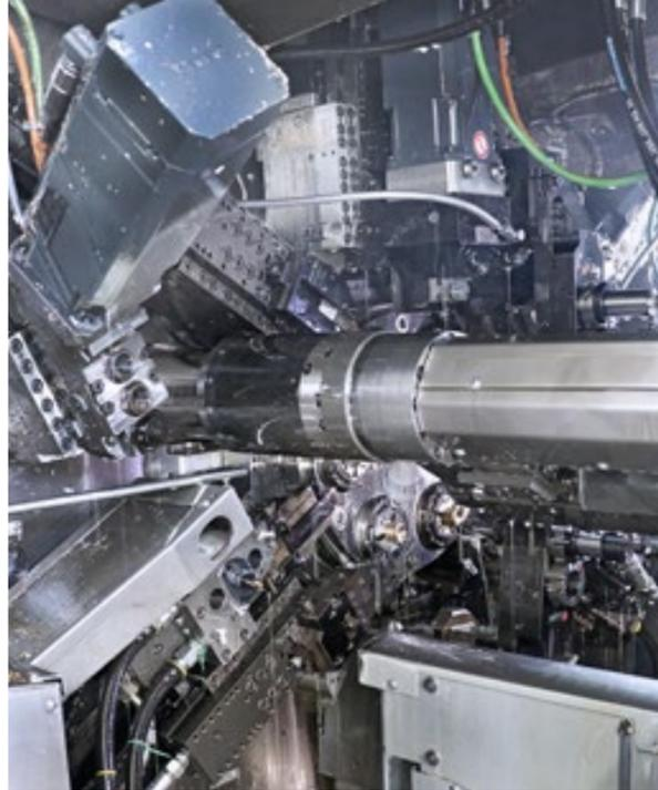
À gauche : les tours multibroches CNC offrent de nombreuses possibilités d'usinage et sont déjà rentables pour des séries de 10 000 pièces.
